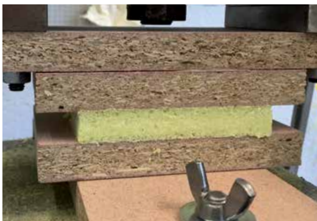
Fot. 06: Urządzenie testowe do określania zdolności kompensacji przemieszczeń
