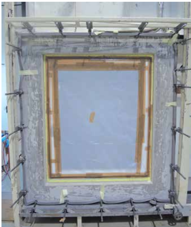
Fot. 05: DuPont™ Insta Stik™ Flex+ na stanowisku testowym w Holzforschung Austria
