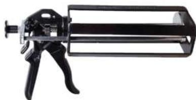
Profesionální aplikátor s hliníkovým tělem. Ocelová tlakově litá páka. Rukojeť a tlačítko pro uvolnění tyče potažené PVC. Tlačítko pro uvolnění tyče a knoflík pro zatahování tyče z tlakově litého hliníku. Pro použití lepidel a chemických kotev ve dvousložkových kartuších vedle sebe.
