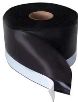
Hydroizolační pás na bázi pryžového butylu s vysokým součinitelem průchodu vodní páry a je částečně pokryt samolepícím butylovým páskem. Výrobek je dodáván v černé barvě a je z obou stran vzorovaný pro maximální přilnavost.
