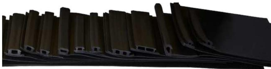
Vnější fólie se systémovým uzávěrem pro instalaci ve fasádních systémech oken a dveří. EPDM je montováno na hliníkový nebo PVC profil pomocí příslušného systémového klipu. Šířka fólie od 100 mm do 1000 mm, dodáváno v rolích po 25 m.
