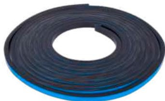
Dvoustranně vysoce přilnavá zasklívací pvc páska s akrylovým lepidlem speciálně vyvinuta pro použití v systémech strukturálního zasklívání. Má částečně otevřenou strukturu pórů k usnadnění vulkanizace strukturálních silikonů ze všech stran.
