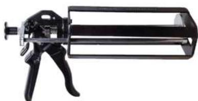
Profesionální aplikátor s hliníkovým tělem. Ocelová tlakově litá páka. Rukojeť a tlačítko pro uvolnění tyče potažené PVC. Tlačítko pro uvolnění tyče a knoflík pro zatahování tyče z tlakově litého hliníku. Pro použití středně/vysokoviskózních lepidel a tmelů, ve dvousložkových kartuších vedle sebe.
