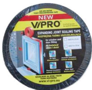
Expanzní těsnící páska z elastického polyurethanu s otevřenými póry, impregnovaná akrylovou pryskyřicí. Po instalaci materiál expanduje a vytvaruje se podle šíře spoje za tvorby elastického utěsnění. Páska je jednostranně pokryta lepidlem pro snadnější instalaci ve spojích.
