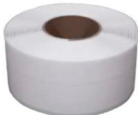
Paropropustná páska s lepicí vrstvou umožňující trvalé připevnění k rámu okna. Chrání se tím izolační vrstva proti dešti a zároveň umožňuje difúzi vodní páry z okenní spáry.
