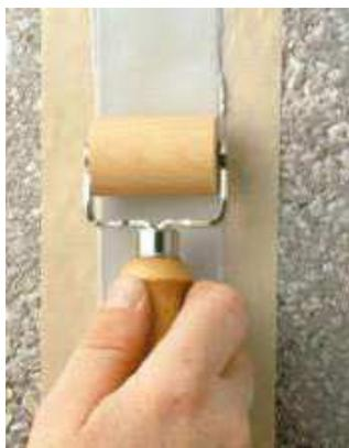
Vi-Pro® SMSILICONE MEMBRANE je to prefabrikovaná, trvale elastická gumová páska vytvrzená při vysoké teplotě, bez plastifikátorů, odolná vůči stárnutí a UV záření. Slouží k utěsnění stavebních spojů, zvláště k opravám vadných spojů mezi stavebními prvky.
