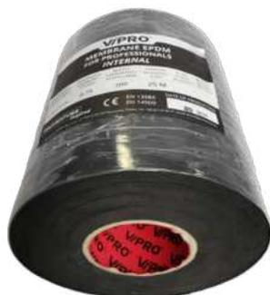
Hydroizolační fólie Vi-Pro® EPDM MEMBRANE INTERNAL je vyrobena na bázi syntetické pryže s vysokým součinitelem propustnosti vodní páry. Používá se pro utěsnění okolo okenních rámců a/nebo vnitřních zatížených konstrukcí. Systém Vi-Pro® EPDM Fólie poskytuje souvislou izolaci proti vlhkosti, je trvanlivá, ohebná a odolná ke konstrukčním pohybům. Je dostupná v černé barvě a povrch fólie má dezén otisku textilie pro zajištění maximální přilnavosti.
