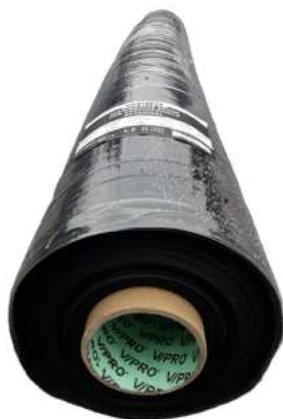
Hydroizolační fólie Vi-Pro® EPDM MEMBRANE EXTERNAL je vyrobena na bázi syntetické pryže s vysokým součinitelem propustnosti vodní páry. Používá se pro utěsnění okolo okenních rámců a/nebo vnějších zatížených konstrukcí. Systém Vi-Pro® EPDM Fólie poskytuje souvislou izolaci proti vlhkosti, je trvanlivá, ohebná a odolná ke konstrukčním pohybům. Je dostupná v černé barvě a povrch fólie má dezén otisku textilie pro zajištění maximální přilnavosti.
