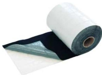
Samolepící hydroizolační pásy na bázi pryžového polymeru EPDM. Výrobek sestává z 1,0 mm tlusté EPDM fólie vyztužené tkaninou s nanesenou vrstvou 0,6 mm lepivého butylu, který je pokryt ochrannou páskou. EPDM a samolepící butyl spolu poskytují výrobek s vysokým součinitelem propustnosti vodní páry. Vi-Pro EPDM BUTYL LAYER dostupný v černé barvě.
